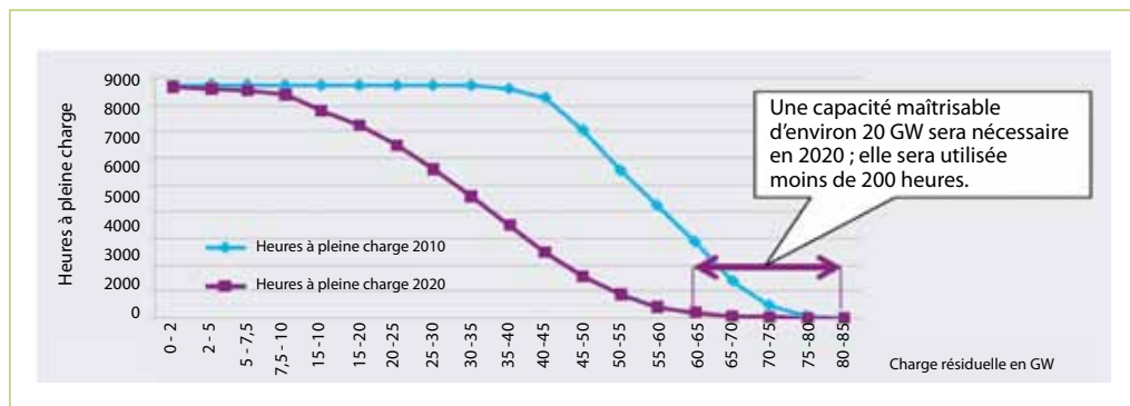
Graphique 8 : Demande de capacité de réserve (« back-up ») flexible et maîtrisable pour répondre à la charge de pointe maximale.
